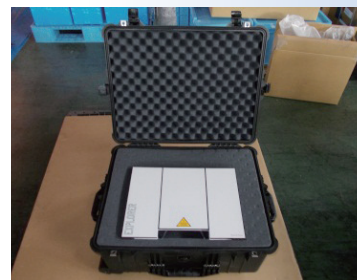
衛星通信装置（固定式）
