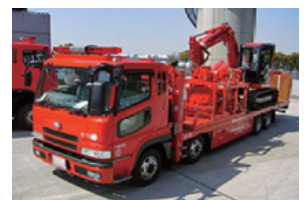
重機及び重機搬送車
